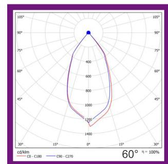
Spot led de uso interior norma IP20, indicado para espacios comerciales por rendimiento lumínico, su chasis en aluminio fundido permite una excelente disipación de calor, su base de conexión es de 3 vías ( línea, neutro y tierra), orientable 360° grados, manejo de 2 ópticas 24° y 60°, esto permite manejar una iluminación puntual y general con un mismo modelo. Lúmenes x vatio 85 LM x W.
